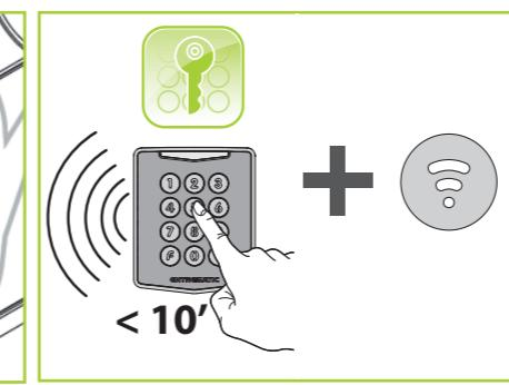
Innerhalb von 10 Sek. Werkscode übertragen und anschließend das FUNKWELLE-Symbol drücken.
