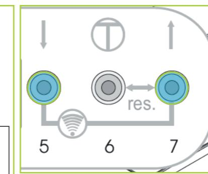
Bei Magic Antrieb Tasten 5 &amp; 7 gleichzeitig für 2 Sek. drücken
