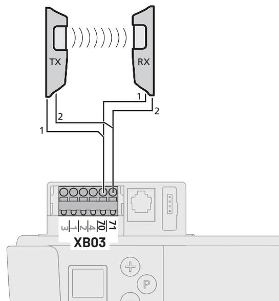
La commande détecte automatiquement une barrière lumineuse raccordée dès lors que l'alimentation électrique est raccordée. La barrière lumineuse peut être reprogrammée ultérieurement. Les barrières lumineuses non souhaitées doivent être déconnectées avant de raccorder l'alimentation électrique, car sinon la commande les détectera.
