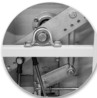
stabiles Getriebe und vor Stößen geschützter Motor (PA68)
